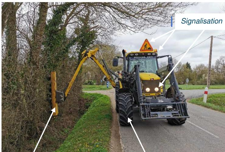
*Le lamier doit être positionné de manière parallèle au tracteur, selon les exigences suivantes :*
